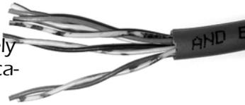
2. Untwist & straighten wires.
