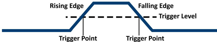
Figure 5.9 Edge Trigger
