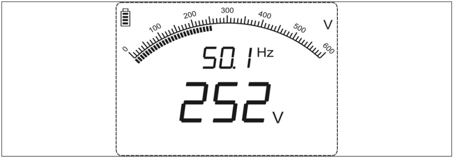
Fig. 14 Voltage Function Display
