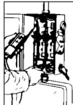
Con la alimentación eléctrica conectada: Ponga el instrumento entre el lado de "alimentación" de un fusible y el lado de carga de uno contiguo. Si no se indica ningún voltaje o se indica un bajo voltaje, el fusible junto a la sonda del lado de carga está fundido. Si se indica el voltaje de linea, el fusible junto al lado de carga está en buenas condiciones. Repita la misma prueba con las sondas en el lado opuesto de los mismos dos fusibles para comprobar el otro fusible.
