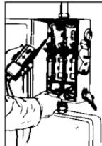
L'alimentation étant active : Placer le testeur sur le côté « source » d'un fusible et sur le côté charge d'un fusible voisin. Si une tension nulle ou faible est indiquée, le fusible voisin de la pointe de contact du côté charge est fondu. Si une tension de secteur est indiquée, le fusible voisin de la pointe de contact du côté charge fonctionne normalement. Répéter ce test avec les pointes de contact sur le côté opposé des mêmes deux fusibles afin de vérifier l'autre fusible.
