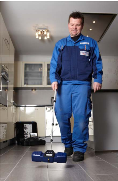
Abb. 4: Lokalisierung des Kamerakopfes im Boden
