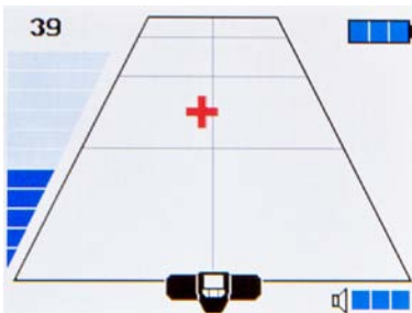
Abb. 3. Lokalisieren des Kamerakopfes
