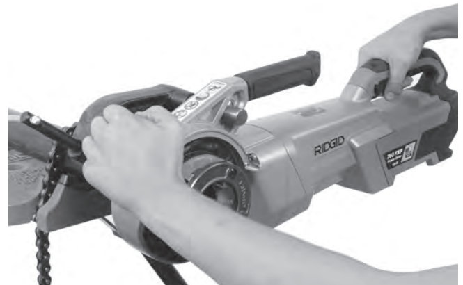
Abbildung 13B - Gewindeschneiden mithilfe des Druckkissens starten
