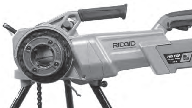
Figura 11 – Orientación correcta del accionamiento motorizado 760 FXP
