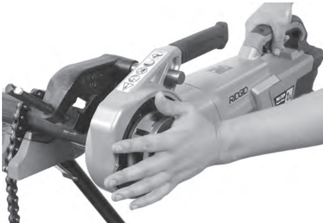
Abbildung 13A - Gewindeschneiden mithilfe der Schneidkopfabdeckplatte starten
