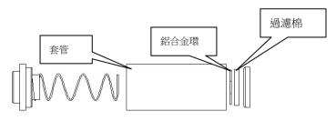
5.3 將彈簧放回套管內,將套管裝回原位。 將後蓋往前推,旋鈕將會往下壓並自動鎖定。
