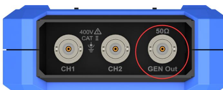
图 6-1: Generator Output Ports
