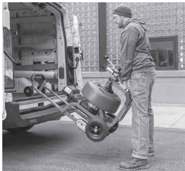
Figura 26 – Cómo subir la máquina al camión
