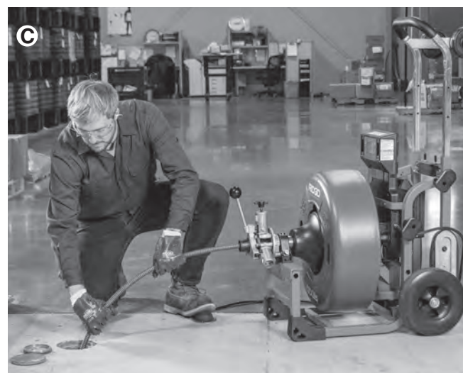
Figure 20A,B,C – Avancement manuel du câble
