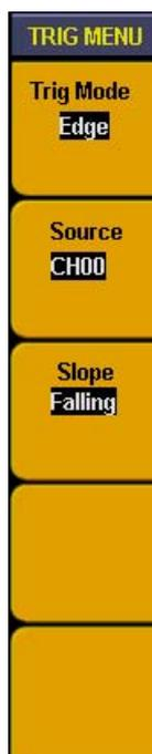
Fig.5-54: Edge trigger menu
