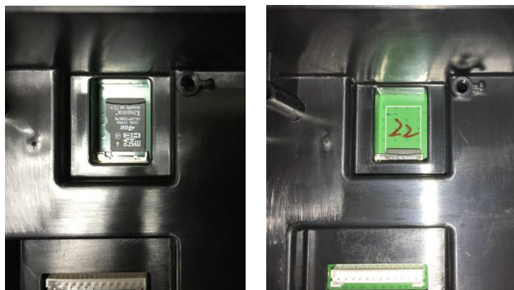
Figura 2-5 Scorrimento di una Scheda SD nella Presa SD (a sinistra); Scheda SD Installata (a destra)
