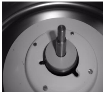
Eje del motor y cámara
