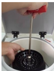
Werkzeug für Rotor mit Mutter
