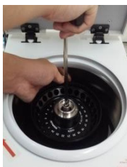
Werkzeug für Rotor ohne Mutter
