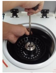
Herramienta para rotor sin tuerca
