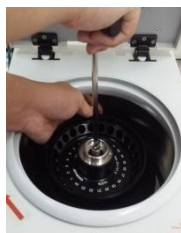
Utensile per rotore senza dado
