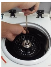
Outil du rotor sans écrou
