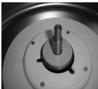
Motorwelle und Kammer
