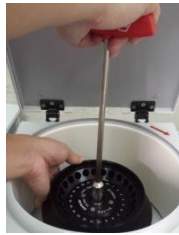
Herramienta para rotor con tuerca
