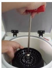
Utensile per rotore con dado
