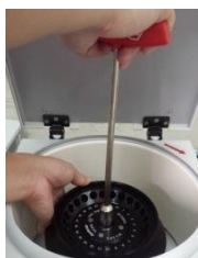
Outil du rotor avec écrou
