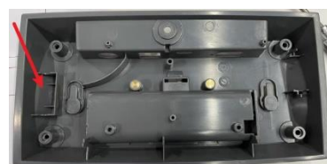
Fije el núcleo de ferrita en carcasa
