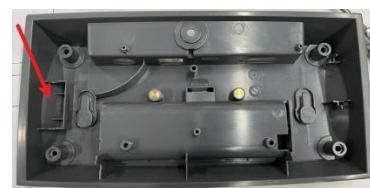
Fissare il nucleo in ferrite sull'alloggiamento
