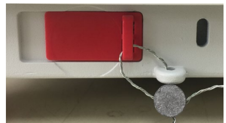
Bloccato con Sigillo di Cavo
