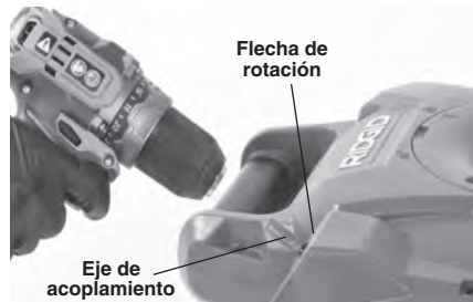
Figura 4 – Conexión del taladro al eje de acoplamiento
