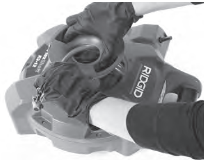
Figure 7C – Introduction du câble à travers le trou du capuchon
