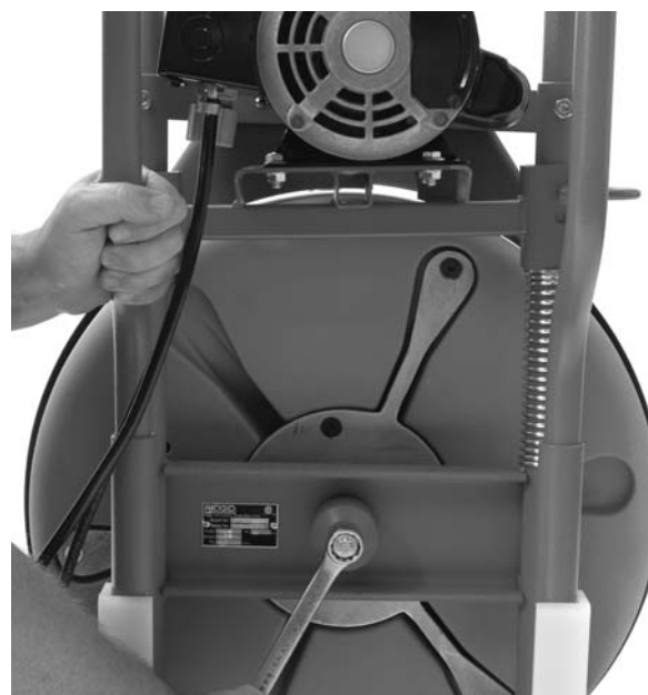
Figure 18 – Retrait du boulon du tambour
