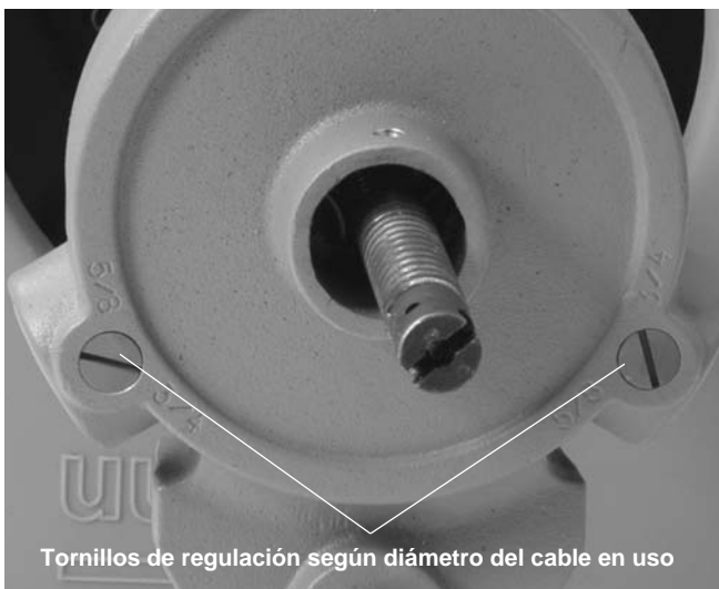
Figura 9 – Tornillos de regulación en la AUTOFEED
