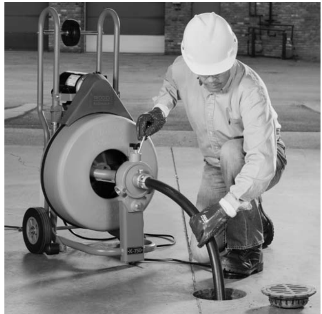
Figure 15 – Utilisation du dégorgeoir avec guide-câble
