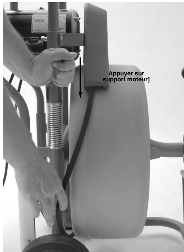
Figure 17 – Pour détendre la courroie
