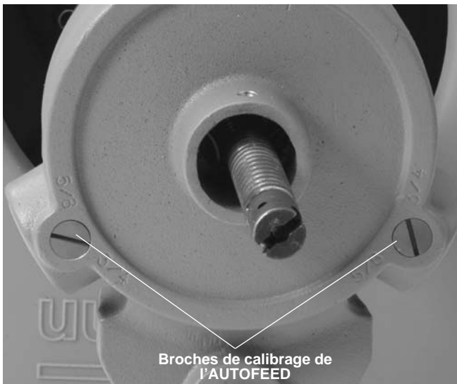
Figure 9 – Broches de calibrage de l'AUTOFEED
