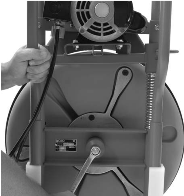
Figura 18 – Extracción del perno que fija el tambor al bastidor
