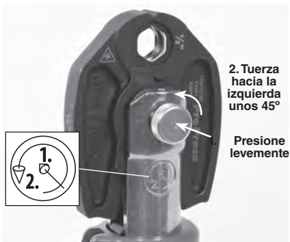
Figura 7 – Apertura del pasador de montaje de accesorios
