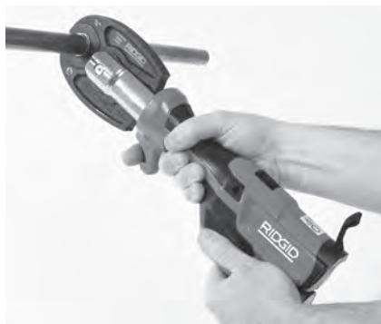
Figura 11 – Selladura del acoplamiento
