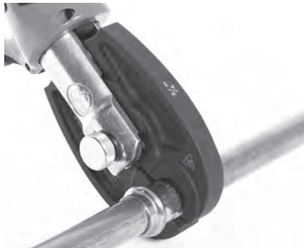
Figure 9 – Positionnement des mâchoires autour du raccord
