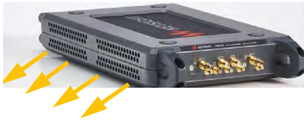
Fan Exhaust Side
