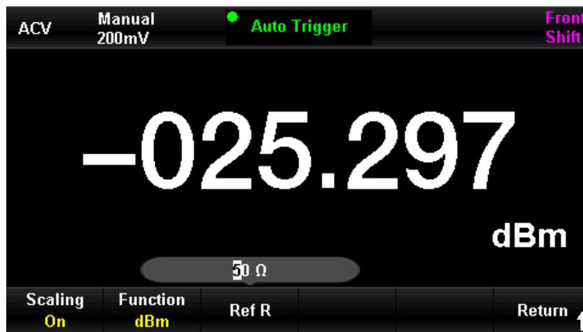
Figure 0-74 dBm Measurement Menu
