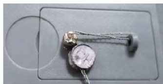
Sellado mediante cable
