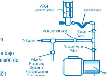
El VG64 debe conectarse al sistema de vacío en la toma de vacío. La "Toma Auxiliar" esta destinada principalmente a funciones de limpieza y debería normalmente estar cerrada con la tapa provista a tal efecto. Es posible conectar el Vg64 en linea; de todos modos, puede limitar el caudal e incrementar el tiempo de evacuación.
